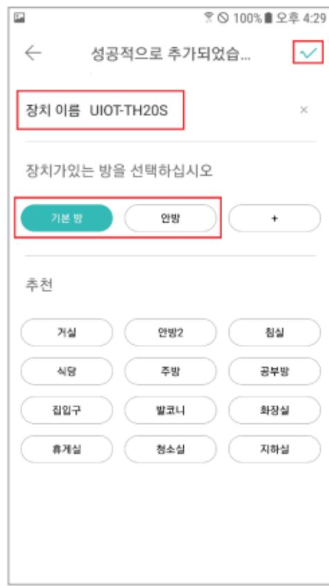
5. 장치 추가가 완료되면 메인 화면에 장치 아이콘이 생성되며, 장치아이콘을 클릭하여 온/습도 정보와 최근 24시간 변화 그래프를 확인할 수 있습니다.
