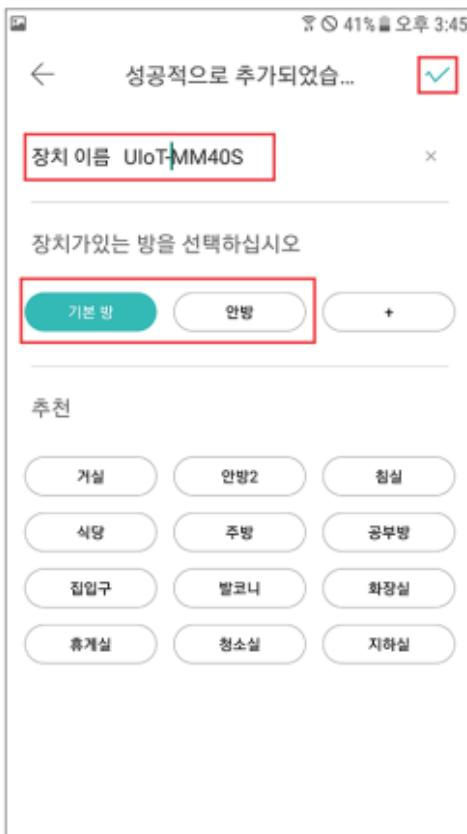
5. 장치 추가가 완료되면 메인화면에 장치 아이콘이 생성되며, 연출(IFTTT)메뉴에서 모션센서 설정을 통한 연동이 가능해집니다.
